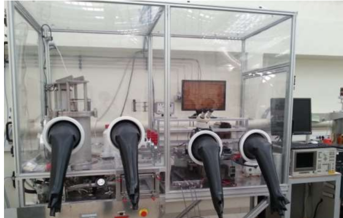
Figure 37: Boîte à gants intégrant un évaporateur effet Joule et une station sous pointes conçue et fabriquée à l'IETR.
