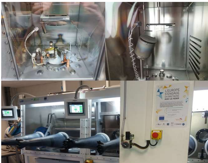
Figure 45: Evaporateur par effet Joule multi-source et pulvérisateur cathodique intégrés en boîte à gants acquis dans le cadre du sous-projet CPER2014-2020 ORGAFLEX.
