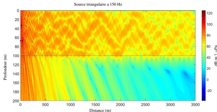
FIGURE 2.10 – Champ sonore (en dB ref  $1\mu\text{Pa}$ ) produit par une source triangulaire sur un milieu à deux couches (l'eau et le sol). Modélisation dans le domaine temporel par une méthode aux éléments finis. Figure tirée de Hafla et al. 2018 [54].
