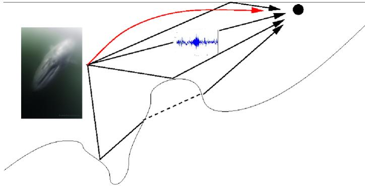
FIGURE 1.11 – Schéma de principe de fonctionnement d'une localisation à un seul hydrophone : le peu d'information dû à l'utilisation d'un seul capteur est partiellement compensé par la richesse de la modification du signal par l'environnement.
