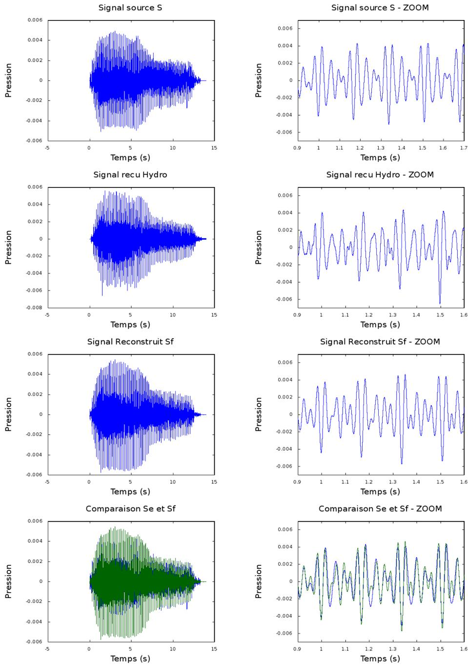
FIGURE 6.12 – Les étapes de la méthode de vérification des propriétés du retournement temporel. Sur chaque ligne, on montre d’abord le signal entier (à gauche), puis un zoom entre les dates  $t_1 = 1$  s et  $t_2 = 2$  s (à droite). Première ligne : signal émis  $S_e$  ; deuxième ligne : signal reçu à l’hydrophone,  $S_{rH}$  ; troisième ligne, signal reconstitué  $S_f$  ; quatrième ligne, comparaison entre le signal émis  $S_e$ , en bleu, et le signal reconstitué  $S_f$ , en vert. .
