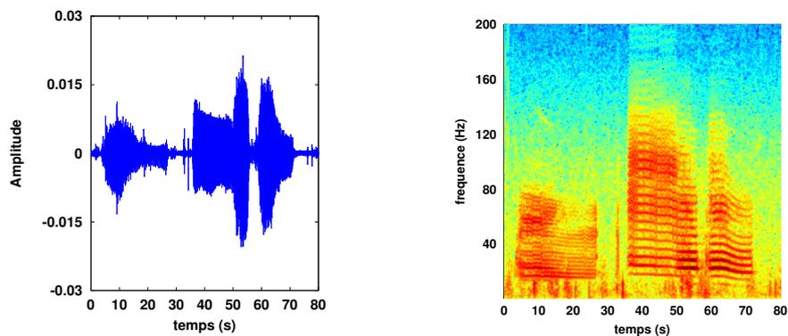
FIGURE 3.8 – Chant caractéristique de la baleine bleue du Pacifique sud-est en forme d'onde (à gauche) et en représentation temps-fréquence, avec une FFT de  $2^{16}$  points, fenêtre Blackman et chevauchement de 75% (à droite).
