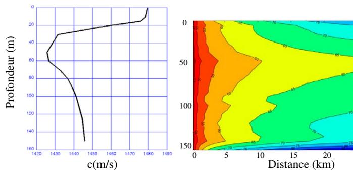
FIGURE 2.8 – Profil de vitesse du son dans la mer Baltique et pertes par transmission (TL) calculées grâce à un modèle de propagation par modes, dans un environnement indépendant de la distance. On note un canal de propagation à basse profondeur (forte insonification vers 50 mètres de fond). Tiré de Andersson 2017 [4].
