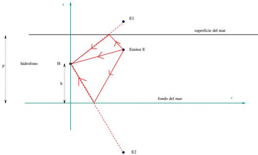
Figure 11: Principe de l'utilisation des TDOA. Le point  $E$  correspond à l'émetteur, le point  $E_1$  est un "émetteur fantôme" et est son symétrique par rapport à la surface de la mer. Le point  $E_2$  est un autre émetteur fantôme, le symétrique de  $E$  par rapport au fond.
