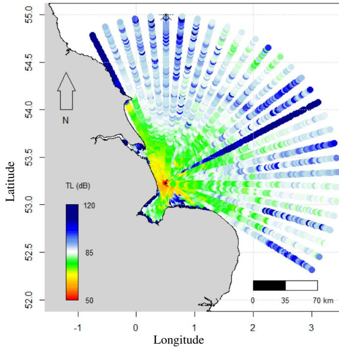
FIGURE 2.9 – Modélisation des pertes par transmission (TL) par un modèle utilisant les équations paraboliques. On notera la forte insonification côtière apparente sur cette simulation. Tirée de Hastie, 2015 [56]
