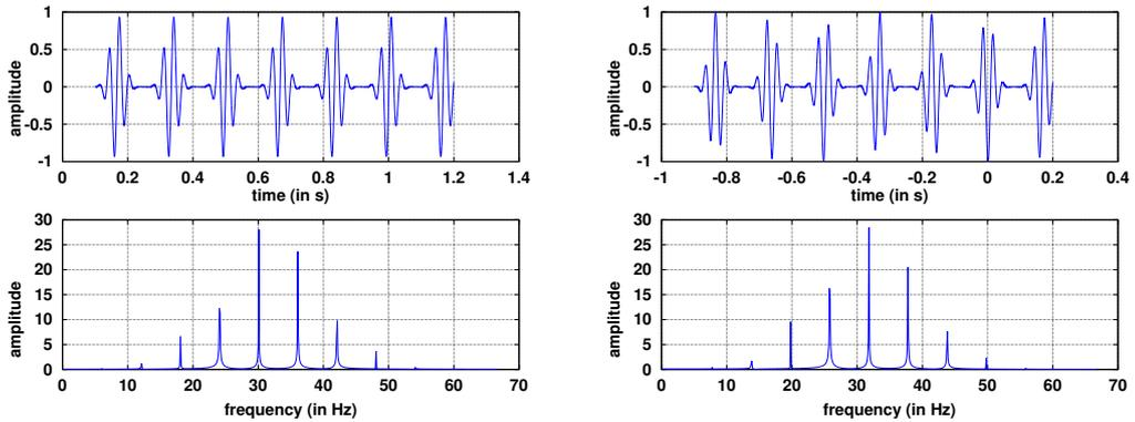
FIGURE 4.6 – Représentation des deux modèles que nous proposons. On constate que le modèle *A* (à gauche) présente des pics de fréquences pour des valeurs multiples de leur écart (6 Hz ici), ce qui n'est pas le cas pour le modèle *B* (à droite) qui montre un peigne lié à la fréquence du signal périodique avant modulation,  $f_0 = 31,7$  Hz.
