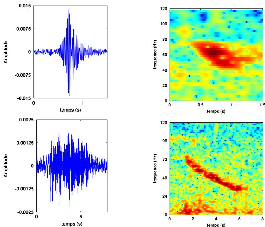
FIGURE 3.9 – Première ligne : downsweeps, attribués aux rorquals communs, en forme d'onde et en temps-fréquence (avec une FFT de  $2^{11}$  points, fenêtre Blackman et chevauchement de 90%). Deuxième ligne : D-calls, attribués aux baleines bleues, en forme d'onde et en temps-fréquence (avec une FFT de  $2^{11}$  points, fenêtre Blackman et chevauchement de 90%).
