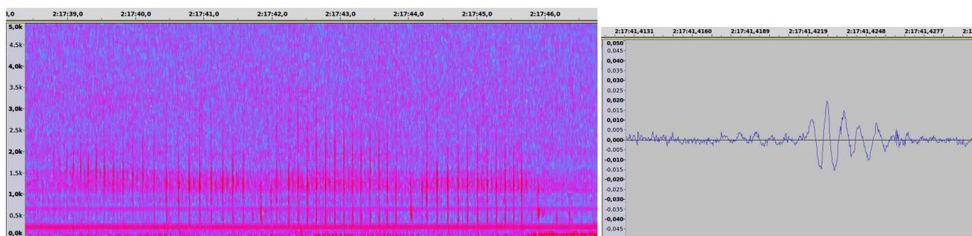
Figure 1: Sons brefs basse fréquence, fichier 170206\_03 de 2h17min38 à 2h17min48, audacity, FFT de 1024 points, fenêtre Blackman (à gauche) Zoom, en forme d'onde, sur un son bref basse fréquence, fichier 170206\_03 autour de 2h17min41.42s (à droite)
