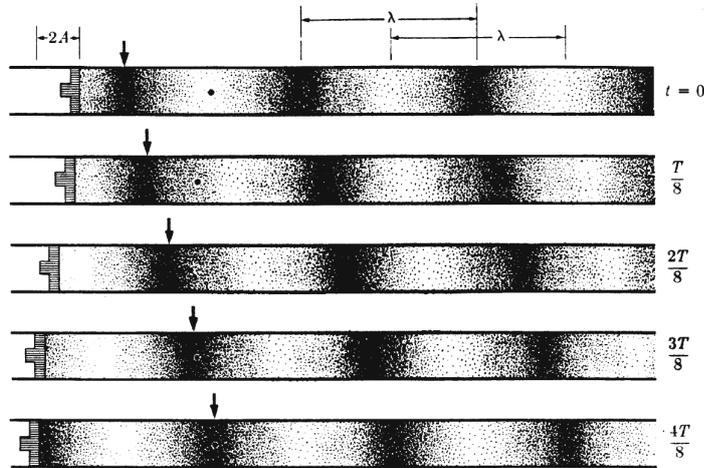
FIGURE 2.1 – Schéma de la propagation d’une onde sonore dans un tube à différents instants. Un piston effectue un déplacement d’amplitude  $2A$  et de période  $T$ , poussant les particules du fluide. Celles-ci présentent alors des zones de sur-densité (compression) et des zones de déplétion (dépression) avec une longueur d’onde  $\lambda$ . Tiré de Rossing, 1990 [119] .
