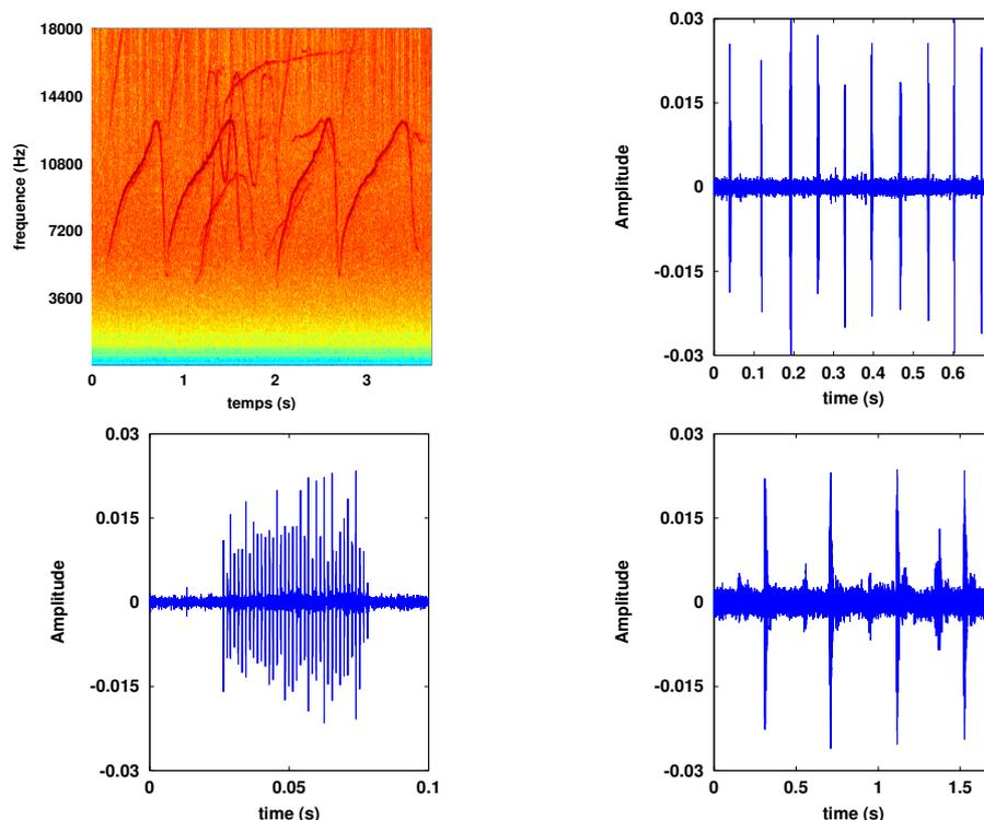
FIGURE 3.10 – Première ligne : à gauche, sifflements caractéristiques de grands dauphins en représentation temps-fréquence, avec une FFT de  $2^{10}$  points, une fenêtre Blackman et un chevauchement de 80% ; à droite, une série de clics d'écholocalisation représentés en forme d'onde. Deuxième ligne : à gauche, burst de clics représenté en forme d'onde ; à droite, sons brefs basse fréquence.
