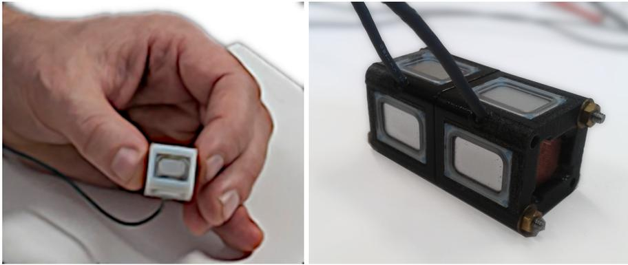
**Fig. 2.14** Cellules de transducteurs développées pour le dispositif de synthèse de champ supersonique, conçues pour être assemblées en ligne. Un haut-parleur électrodynamique miniature est disposé sur chacune des 4 faces externes des cellules.
