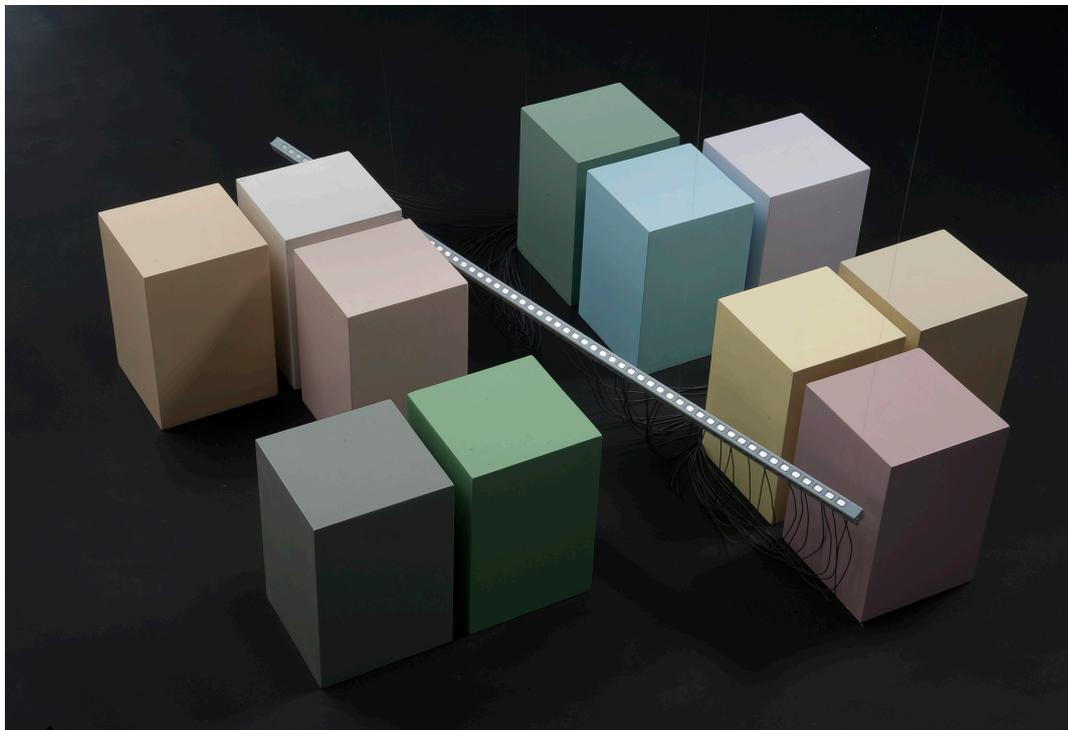
**Fig. 2.15** Photographie de l'une des deux lignes de haut-parleurs d'une longueur de 1 m 28 conçues en collaboration avec l'ISL, entourées de structures diffractantes afin de tester leur effet sur l'onde cônica du projectile simulé.
