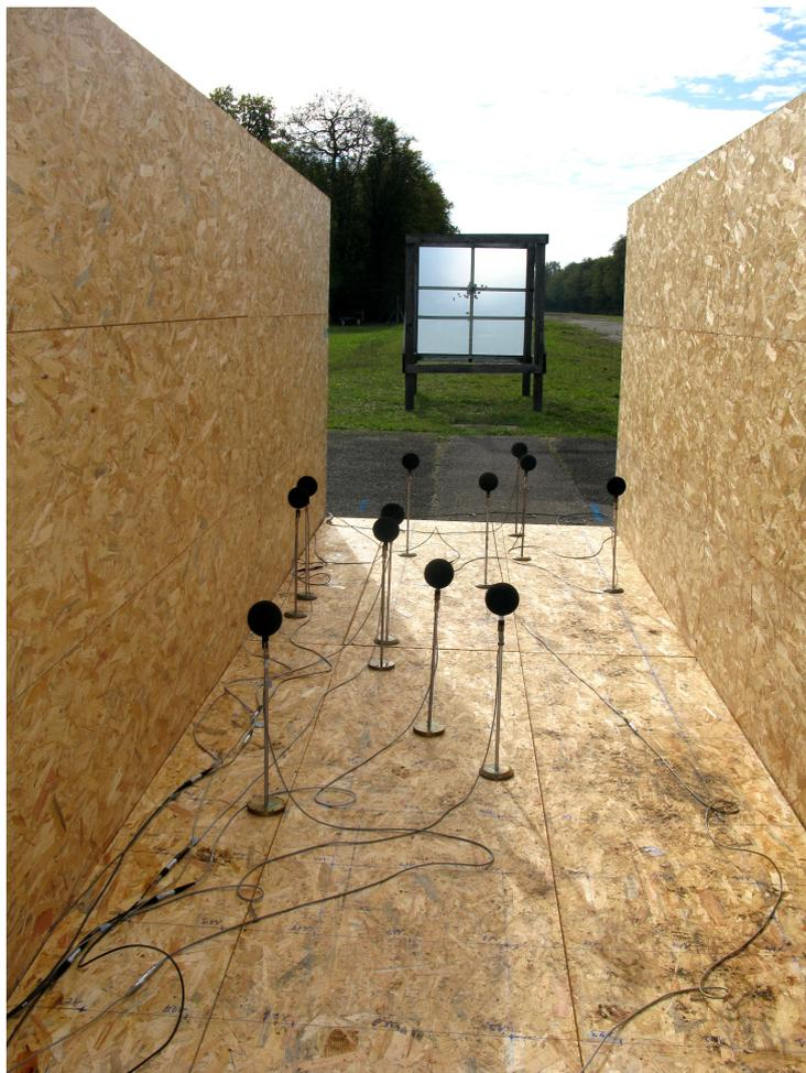
**Fig. 2.27** Photographie de la “maquette” de couloir urbain utilisée pour les tirs à balles réelles lors de la campagne de mesure en fin de thèse de Guillaume Mahenc
