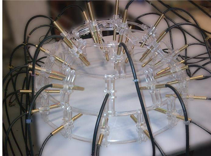
**Fig. 1.2** Antenne hémisphérique utilisée pour la captation double couche.
