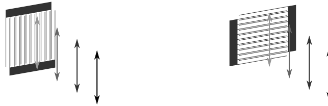
Figure 4.43 : Définition de la polarisation directe et de la polarisation croisée. Les flèches illustrent la polarisation du faisceau incident.
