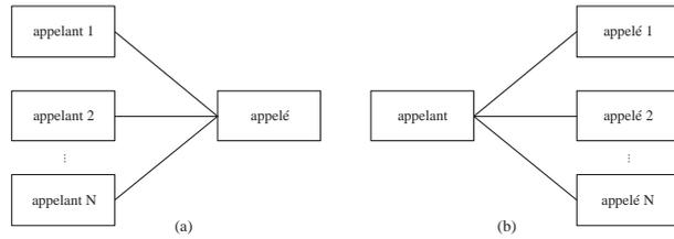
FIG. 3.2 – Connexion complexe. (a) plusieurs appelants - un appelé, (b) un appelant - plusieurs appelés
