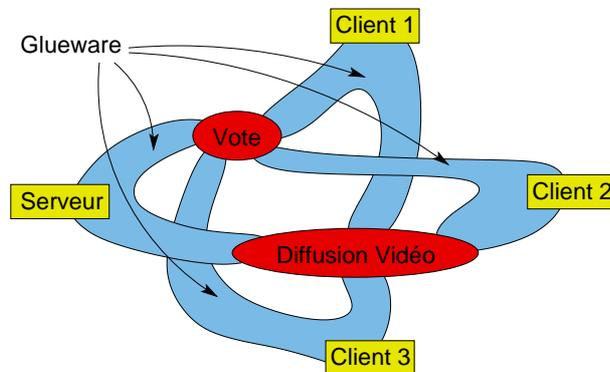
FIG. 3.6 – Nouvelle architecture de l’application de vidéo interactive
