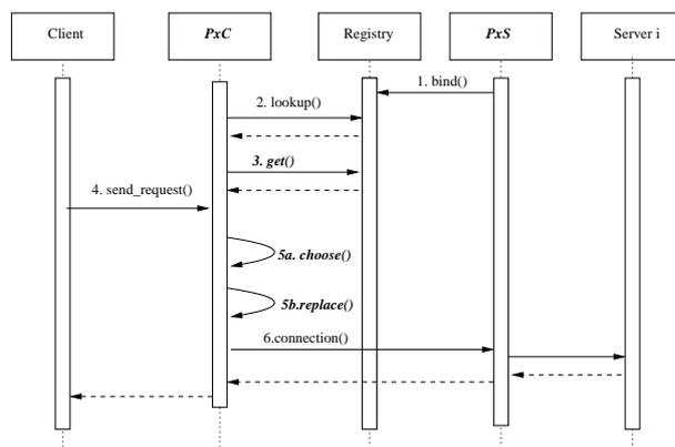
FIG. 3.27 – Équilibrage de charge avec un connecteur
