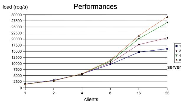
FIG. 3.28 – Performance de l'équilibrage de charge (en requête par seconde)
