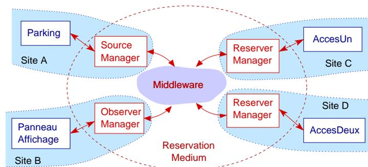
FIG. 3.17 – Architecture de déploiement du médium de réservation
