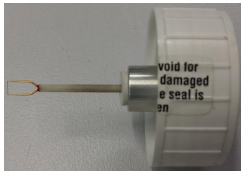
Figure II-24 – Mini CTA hot-film probe, Dantec Dynamics
