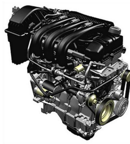
Figure 7 – Moteur trois cylindres atmosphérique
