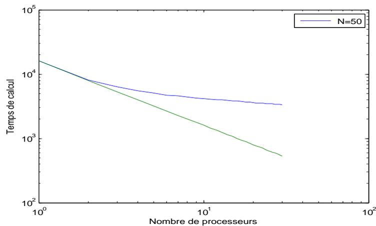
FIGURE 3.10 – "Strong scalability" du problème d'instabilité thermique par la méthode de parallélisation classique.
