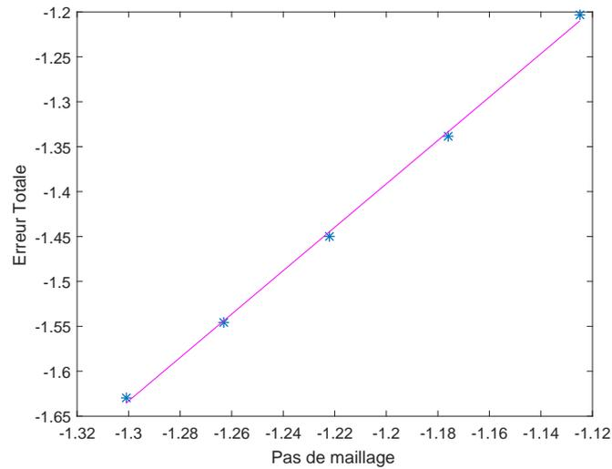
FIGURE 2.11 – Courbe d’erreur totale en échelle logarithmique pour  $\nu(T) = T + 1$ .
