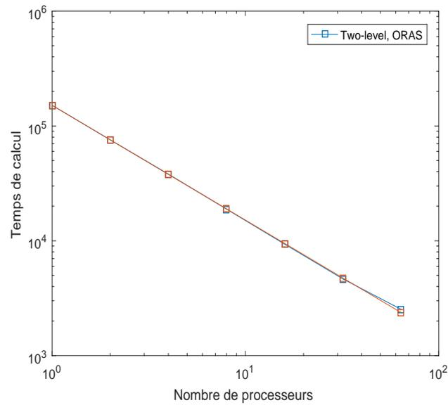
FIGURE 3.13 – "Strong scalability" du préconditionneur à deux niveaux.
