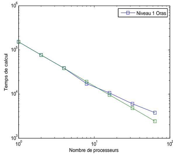
FIGURE 3.11 – "Strong scalability" du préconditionneur à un niveau.
