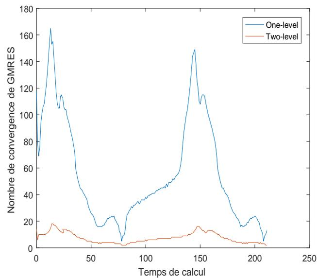
FIGURE 3.14 – Comparaison du nombre d'itérations de convergence de GMRES pour un préconditionnement à un et deux niveaux.
