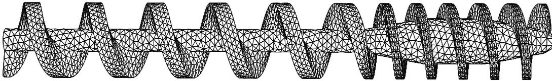
FIGURE 3.16 – Géométrie de la vis à l'intérieur du fourreau.
