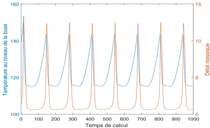
FIGURE 3.7 – Evolution du débit massique (en mg/s) et de la température au cours du temps (en s) en sortie de filière.
