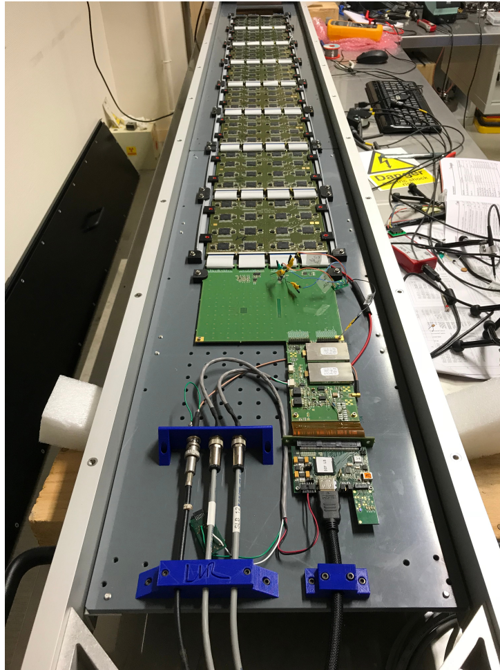
FIGURE 5.40 – Electronique du slab long. Les cartes sont chaînées entre elles par des connecteurs à nappe et reliées à l'électronique de lecture en bout de slab. (Credit J. Nanni, LLR)
