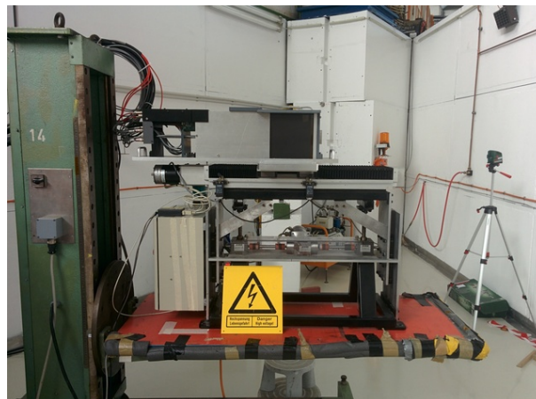
FIGURE 5.30 – Prototype slabs courts sur sa table de déplacement à DESY pour le test faisceau de 2017
