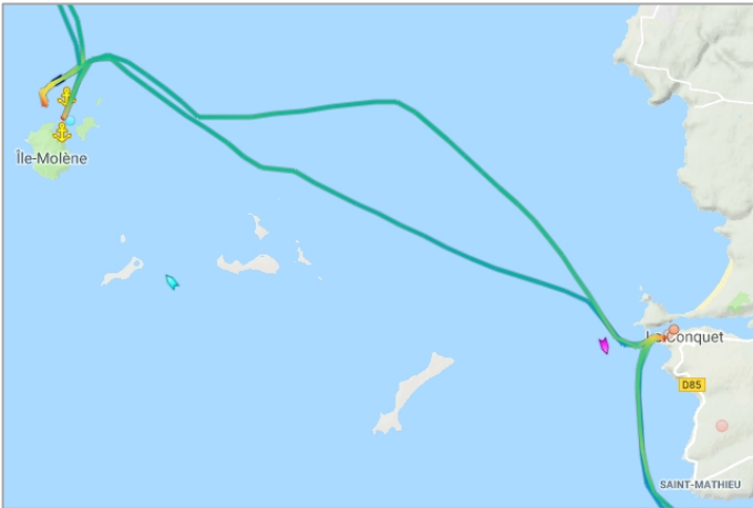
Figure 179 – Les routes entre Le Conquet et Molène selon la marée La route la plus au nord par le chenal de la Helle est possible à marée basse. La route plus directe au sud par le chenal du Cromm n'est possible qu'à marée haute par fort coefficient. (Source : capture Marinetrffic.com)
