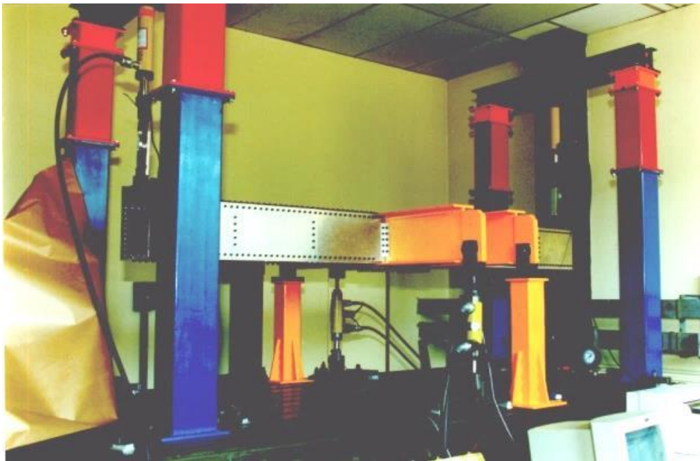
Figure I-2 : Machine d'essais compression/cisaillement ICA [Castanié, 2000]
