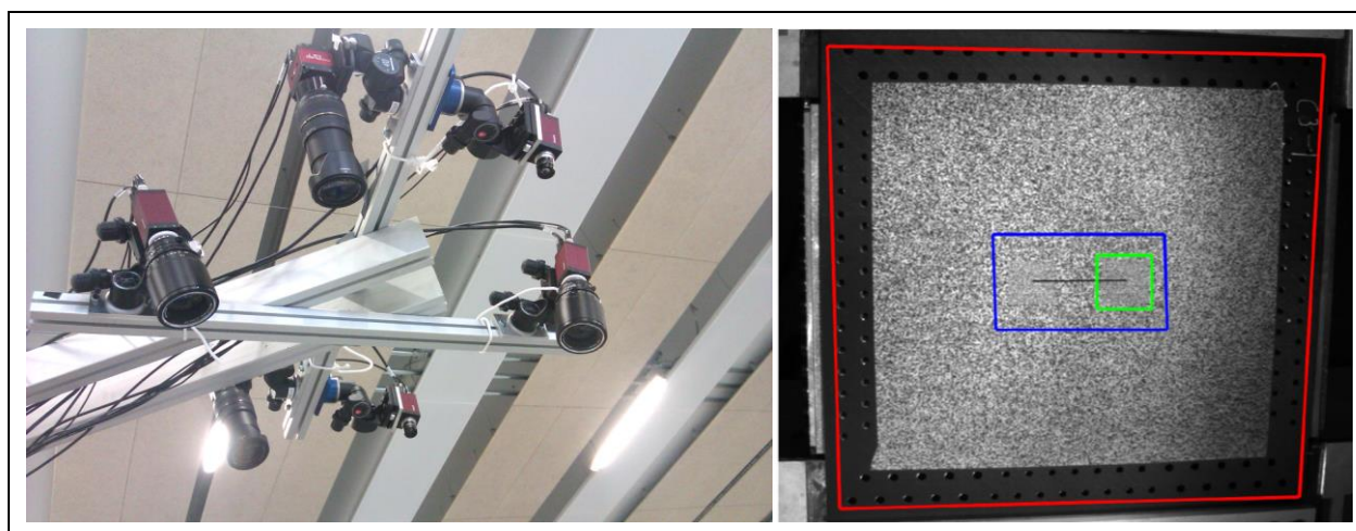
Figure VI-7 : Les trois couples de caméras utilisées pour les expériences VERTEX
