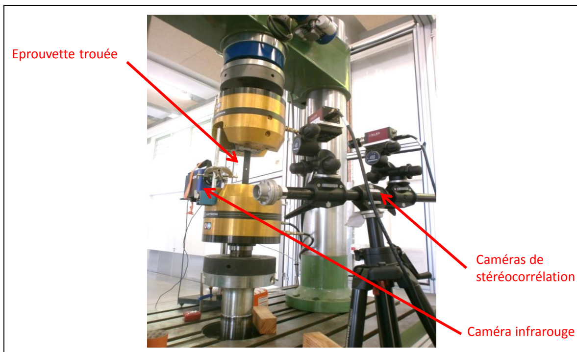
Figure IV-3 : Dispositif expérimental pour un essai de traction quasi-statique de « Grandes » éprouvettes
