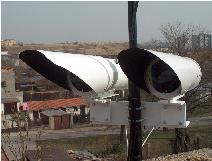
Figure 1.3 – Un des systèmes RONJA installé à Prague (République Tchèque) [4]
