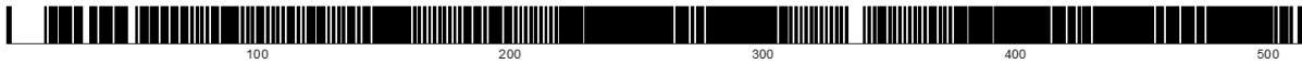
FIGURE 2.36 – Exemple de motif de gravure obtenu pour un laser de 800 \mu\text{m} , \lambda = 417 \text{ nm} , N = 37 . Les zones blanches seront à graver. Les pixels sont indicés de 1 à 513.
