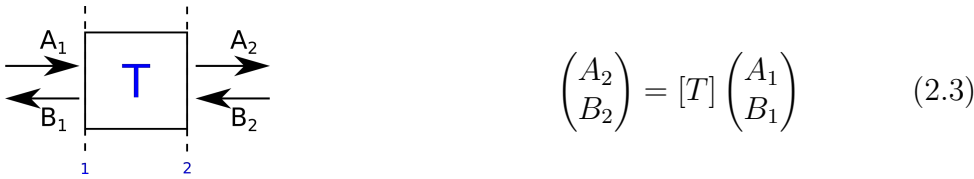
FIGURE 2.27 – Matrice de transfert d'un système optique.
