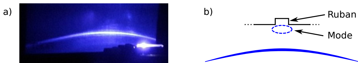
FIGURE 2.52 – a) Faisceau en champ lointain b) Position du faisceau relativement à la diode laser.
