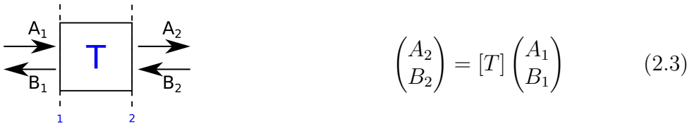
FIGURE 2.27 – Matrice de transfert d'un système optique.
