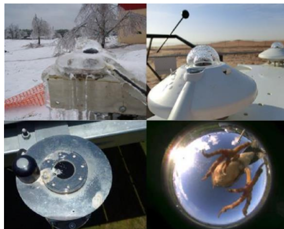
Figure II-7: Exemples de perturbation de la mesure, de gauche à droite et de haut en bas : glace, condensation, présence d'oiseau
