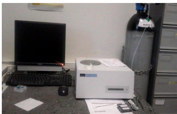
Figure II. 9. Analyseur thermogravimétrique Perkin Elmer Pyris 6 TGA
