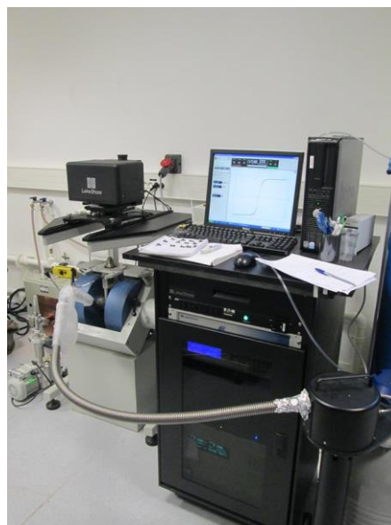
Figure II. 11. Magnétomètre à échantillon vibrant Lake Shore 7400
