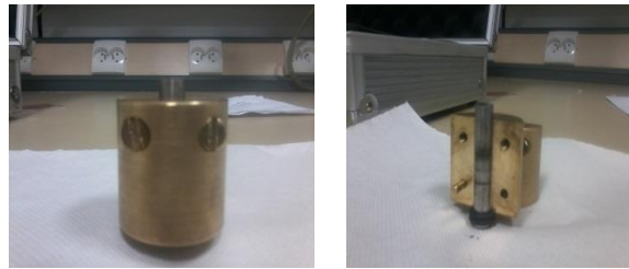
Figure V. 3. Moule utilisé pour la réalisation des tores
