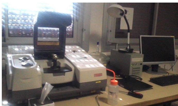
Figure II. 5. Spectromètre infrarouge (IRTF) Thermo Electron-Nicolet type Nexus 670
