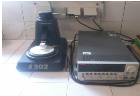
Figure II. 13. Station de mesure des quatre pointes
