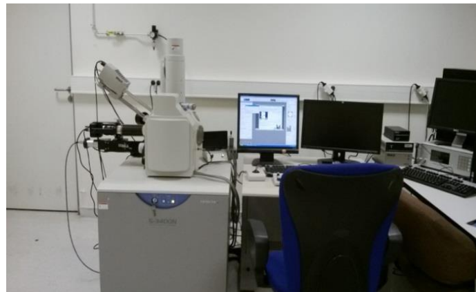
Figure II. 7. Microscope Électronique à Balayage Hitachi S3200N
