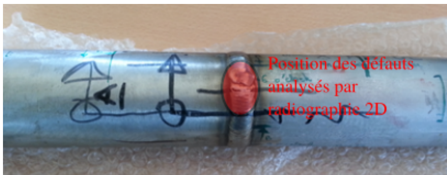
FIGURE 13 – Tube duplex avec présence de défauts.
