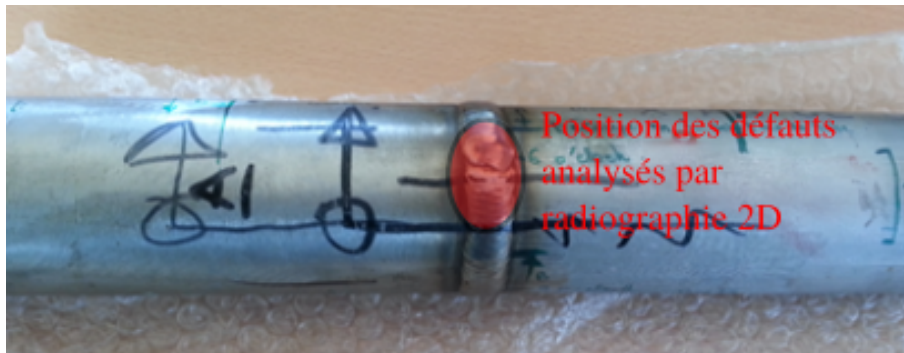
FIGURE 13 – Tube duplex avec présence de défauts.
