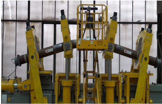
a) Vue du montage expérimental de flexion du tube
