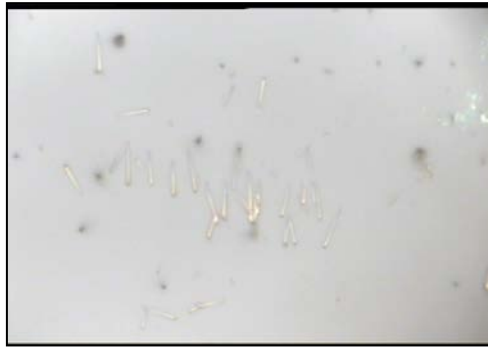
Figure 5. 14: image optique des nanofils de Ge isolés sur un substrat « Surf slide ».
