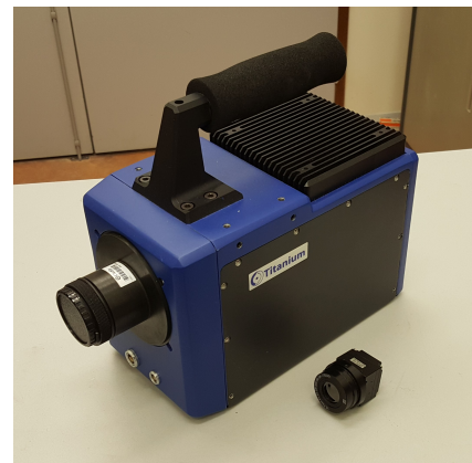
FIGURE 3.1 – Sur la partie gauche de la photo (en bleu) une caméra thermique refroidie, à droite (petite et noire) une caméra microbolométrique
