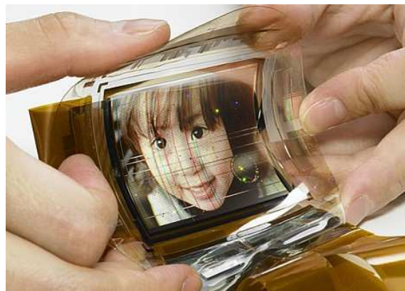
Figure I- 6 : Ecran flexible utilisant une technologie OLED [15]
