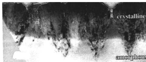
Figure II- 17 : Structure d'une couche de silicium microcristallin d'après J. Kocka [16]
