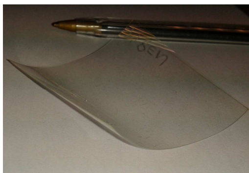
Figure 3. Substrat de PEN Q65F déformé quand il est exposé à une température de 165^{\circ}\text{C} .
