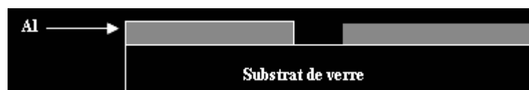
Figure 2. Dépôt d'aluminium et définition des contacts arrière
