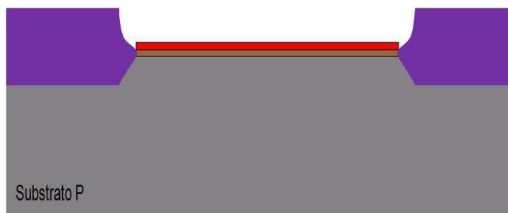
Figura 23: Perfil do dispositivo após crescimento da camada LOCOS.
