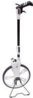
Figure 1.6: Odomètre permettant la mesure de la longueur de foulée entre deux posés d'antérieur directeur successifs
