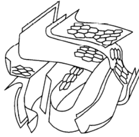
Figure 11. Représentation schématique de la structure d'un charbon activé (Rodríguez-Reinoso et Molina-Sabio, 1998).
