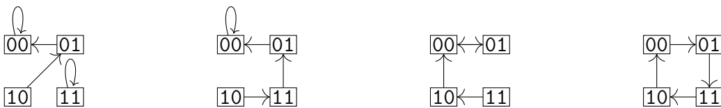
FIGURE 6.3 – Chacun des 26 réseaux h \in F(2, 2) non simulables sans mémoire est une symétrie d'un des 4 réseaux représentés ici.
