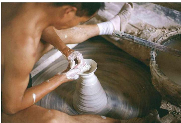
**Figure B10** : Utilisation d'une estèque pour calibrer la courbe des parois du bol et la taille de son ouverture, Jingdezhen.
