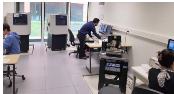
Parc instrumental de microscopes champs proches. Ces derniers sont dotés de systèmes de production de champ magnétique dans le plan ou en perpendiculaire. Deux de ces instruments permettent le lancement de scripts permettant d'explorer une excursion en champ sans qu'une présence humaine soit requise.
