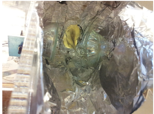
(d) GaIn filled preform in furnace
