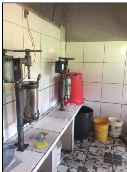
Photographie 6 : Batedeiras d'açaí (une sorte de robot qui permet de séparer les noyaux de la pulpe).
