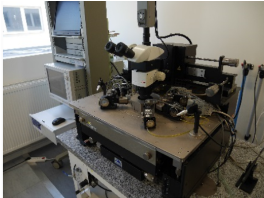
FIGURE 2.6 – Station sous-pointes Cascade 200 mm utilisée pour réaliser la caractérisation électrique des jonctions mémoires unitaires STT-MRAMs.
