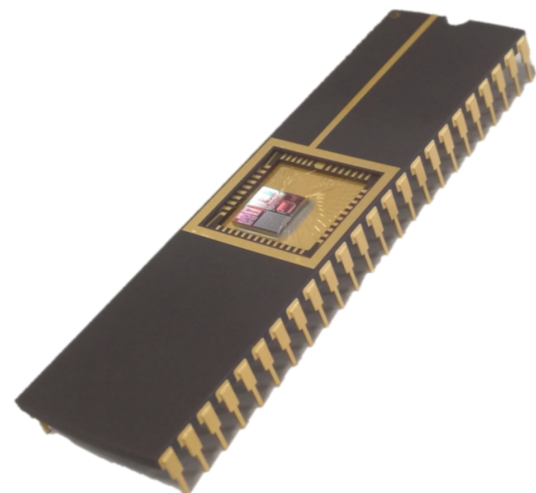
(b) Photographie d'un circuit mis en boîtier.
