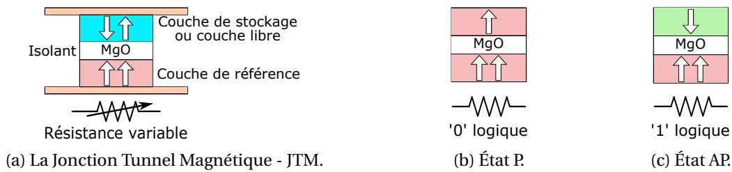
FIGURE 1.11 – Illustration de la Jonction Tunnel Magnétique (JTM) et de ses états.
