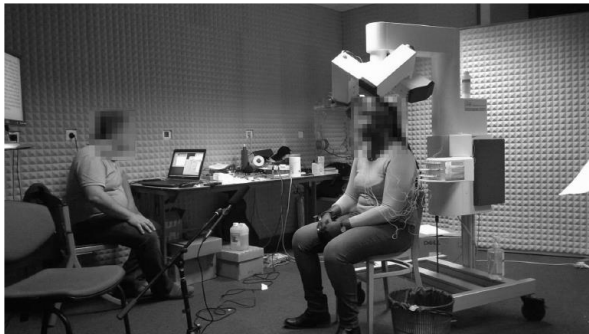
Figure 3. Exemple d'acquisition de données au LORIA (Nancy). A droite, la locutrice se trouve dans l'EMA. A gauche, l'expérimentateur (Photo : Didirková, 2016)
