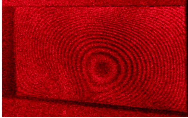
Figure 46 – contrôle holographique de la déformation électrostatique des microgrilles (meshes) du détecteur PIM lors de la variation de tension la tension appliquée [93].
