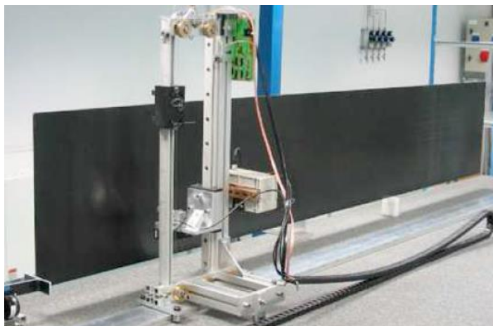
Figure 44 – contrôle de la planéité des supports en composite (CFRP, Carbon Fiber Reinforced Plastic) des détecteurs du système de trajectographie du spectromètre à muons d'ALICE.
