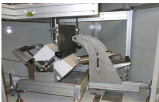
Figure 74 – dispositif expérimental de mesure de rayons X rétrodiffusés ; schéma de principe à gauche (tailles des objets et angles et non significatifs) et expérimentation sur un échantillon de calcaire (au LRPC d’Angers) à droite.
