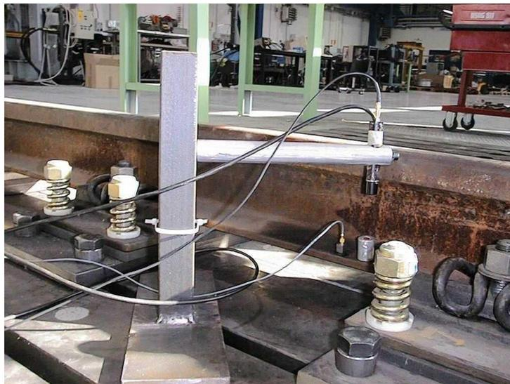
Figure 49 – capteur à rétro injection optique de mesure de déformations et vibrations de rails développé dans le cadre du projet Rolling installé sur le banc de test à Milan.
