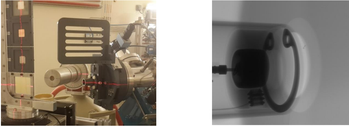
Figure 90 – configuration expérimentale pour la mesure de l'efficacité de détection (détecteur LEGe à 20 cm en face de la cible et des sources (à gauche) ; radiographie du détecteur LEGe (à droite).
