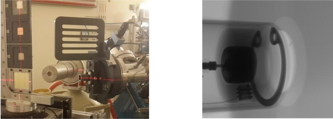
Figure 90 – configuration expérimentale pour la mesure de l'efficacité de détection (détecteur LEGe à 20 cm en face de la cible et des sources (à gauche) ; radiographie du détecteur LEGe (à droite).
