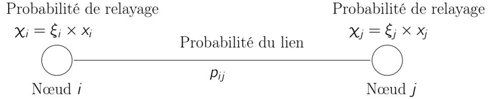
Figure 6.1 – Premier modèle stochastique cross-layer du réseau maillé. Un nœud  $i$  se voit associé une probabilité de relayage  $\chi_i$  et un lien  $(i, j)$  une probabilité de transmission avec succès  $p_{ij}$ .
