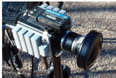
FIGURE 5.10 – Système d'acquisition : la centrale inertielle est solidaire de la caméra.
