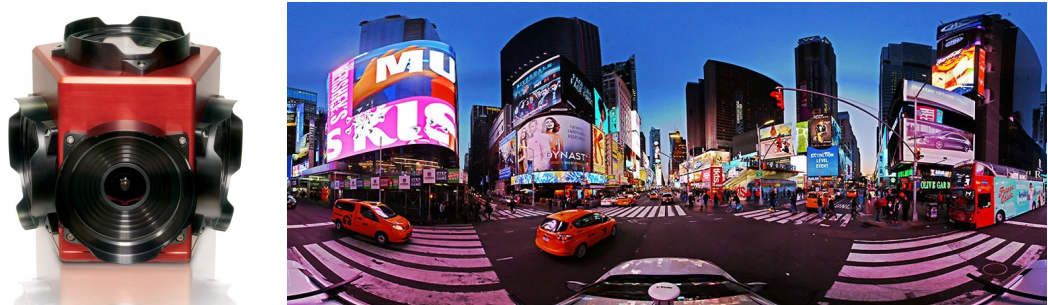
FIGURE 3.3 – Exemple de système omnidirectionnel polydioptrique : (a) caméra Ladybug, (b) image panoramique.
