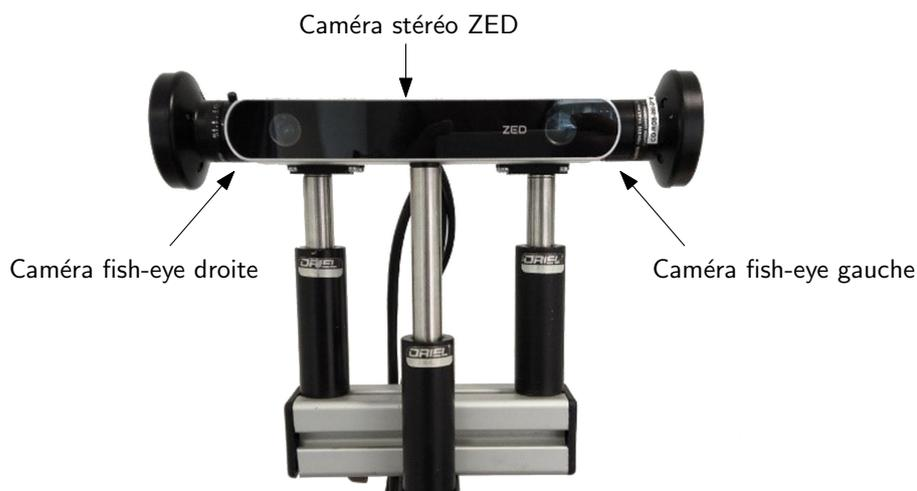
FIGURE 3.8 – Vue de face du prototype proposé.
