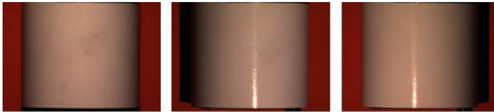
FIGURE 2.7 – Acquisition de trois images avec des directions de sources lumineuses différentes. La réflexion spéculaire est visible sur les images 2 et 3.
