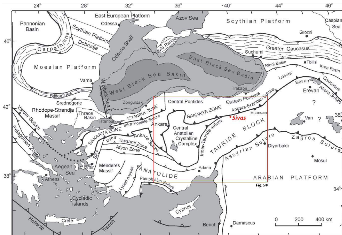
Figure 89 : Carte tectonique de la région Nord-Est de la Méditerranée montrant les principales sutures et blocs. Les sutures sont représentées par les lignes noires épaisses avec la polarité de subduction indiquée par les triangles pleins. Les lignes noires épaisses avec les triangles vides correspondent aux subductions actives. Les traits noirs fins avec des triangles correspondent aux principales zones de ceintures de chevauchements et de plis, d'après Okay (2008).
