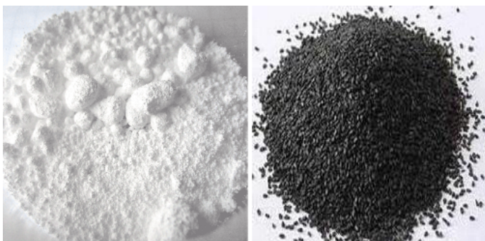
Figure 1.16. Sulfate de baryum, ou baryte en poudre ( BaSO_4 ) avant calcination (poudre blanche) et sulfure de baryum ( BaS ) obtenue après calcination de la baryte. La pierre de Bologne, luminescente, est cette dernière substance.
