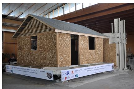
FIGURE 2.16 – La maison réalisée sur la table vibrante
