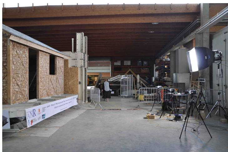
FIGURE 2.26 – Vue globale du système utilisé (mur de cisaillement, éclairage et position de la caméra)
