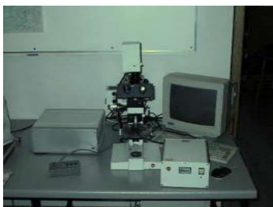
Figure 5 : Microscope Leitz (Ortholux 2 POL BK) avec un objectif de 125x à immersion d'huile utilisant une lumière monochromatique polarisée (546 nm) et un photomultiplicateur MPV de Leitz (Université de Giessen, Allemagne).
