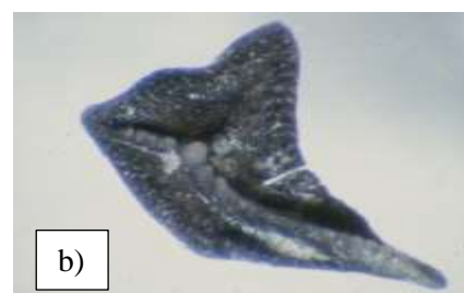
Figure 8 : Exemple de différence de teinte de conodonte en fonction de l'évolution de la température. a) CAI = 2 ; b) CAI = 4.
