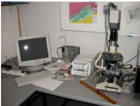
Figure 10 : Table microthermométrique Linkam THM 600/S/Geo couplée à un contrôleur de température TMS 94, installée sur un microscope Olympus (Université de Giessen, Allemagne).
