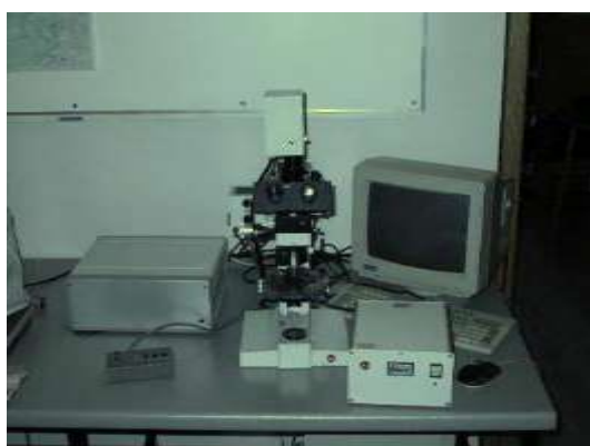
Figure 5 : Microscope Leitz (Ortholux 2 POL BK) avec un objectif de 125x à immersion d'huile utilisant une lumière monochromatique polarisée (546 nm) et un photomultiplicier MPV de Leitz (Université de Giessen, Allemagne).
