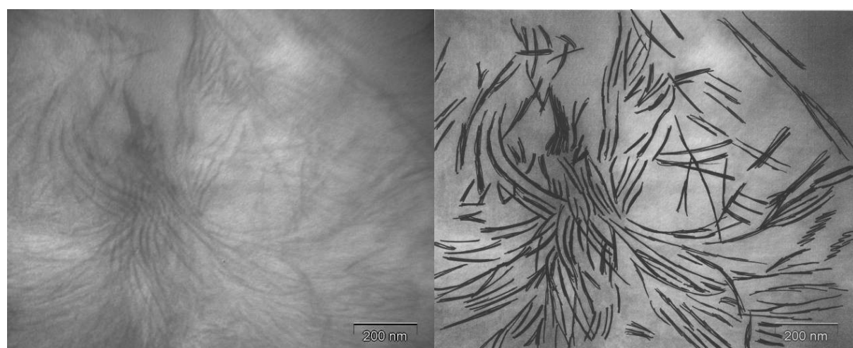
Figure 4-2 – Image MET d'un échantillon de cœur de cylindre de PP003 (35% SR) marqué au RuO 4 à fort grandissement. a) Image originale. b) Les lamelles visibles ont été noircies.
