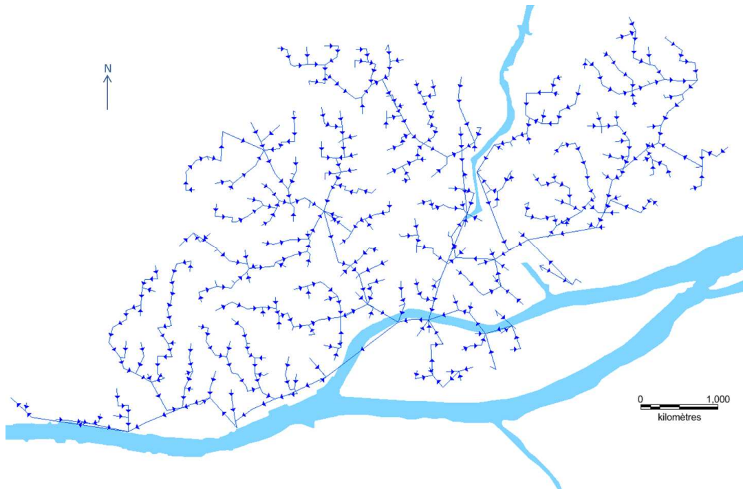
Figure 21 : Représentation simplifiée du réseau unitaire de la ville de Nantes projeté sur une grille de 200m de résolution après correction manuelle de deux arcs.
