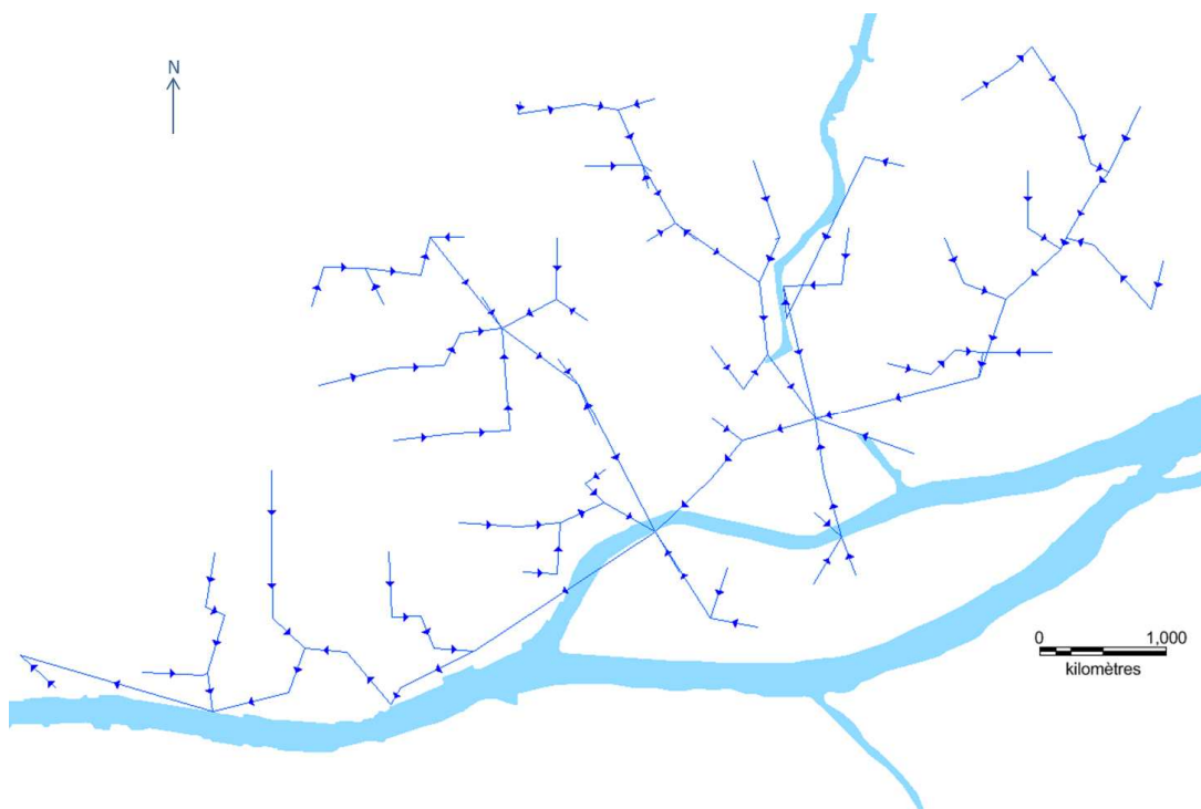
Figure 23 : Représentation simplifiée du réseau unitaire de la ville de Nantes projeté sur une grille de 500m de résolution obtenue sans aucune intervention manuelle. Les points bas responsables des mauvaises connexions sont entourés en rouge.
