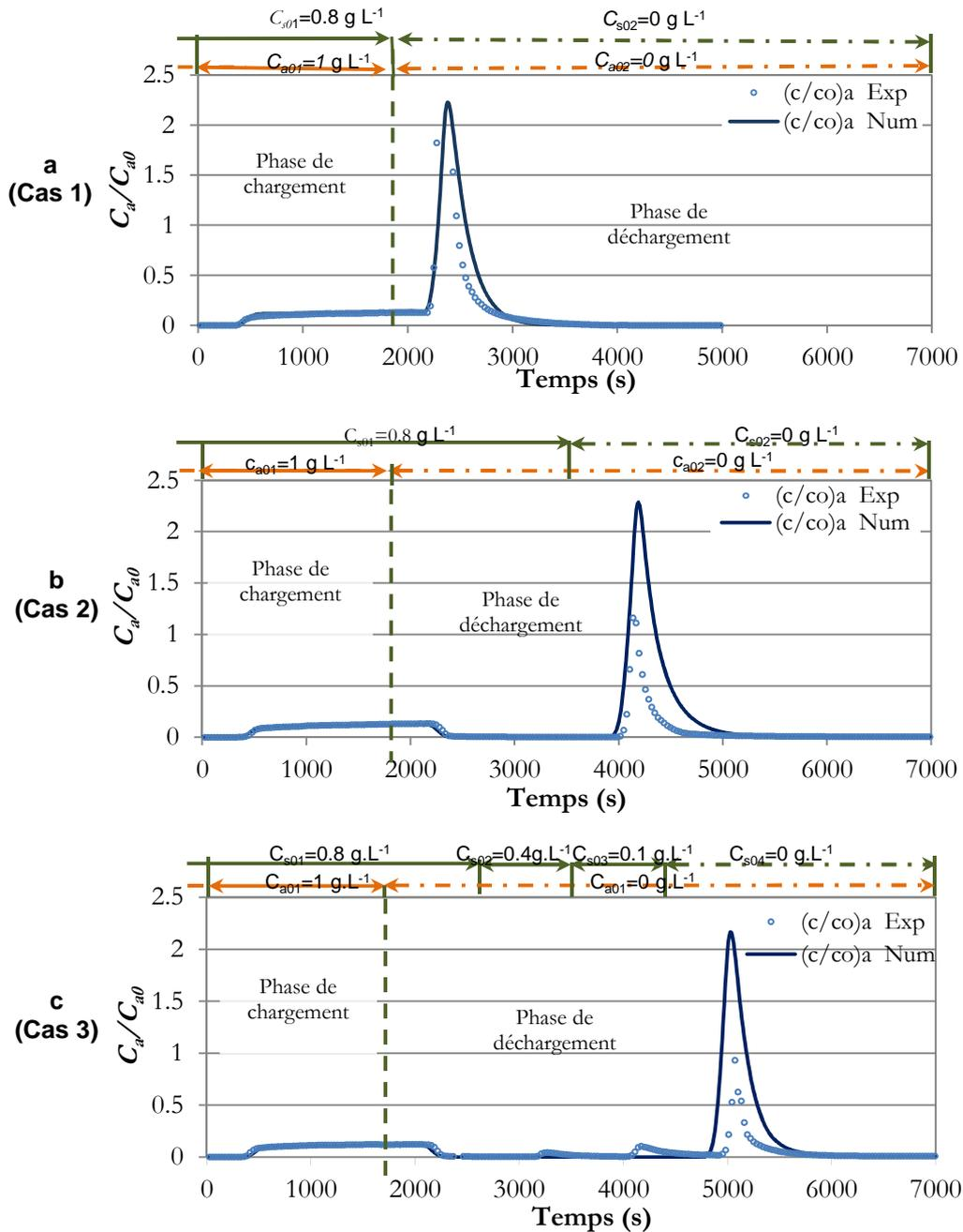
Figure 9. Simulation des expériences non monotones: évolution de MES restituées ( $C_a/C_{a0}$ ) en fonction du temps sous différentes forces ioniques  $I$  ( $q_w = 5.19 \cdot 10^{-2} \text{ cm.s}^{-1}$ )
