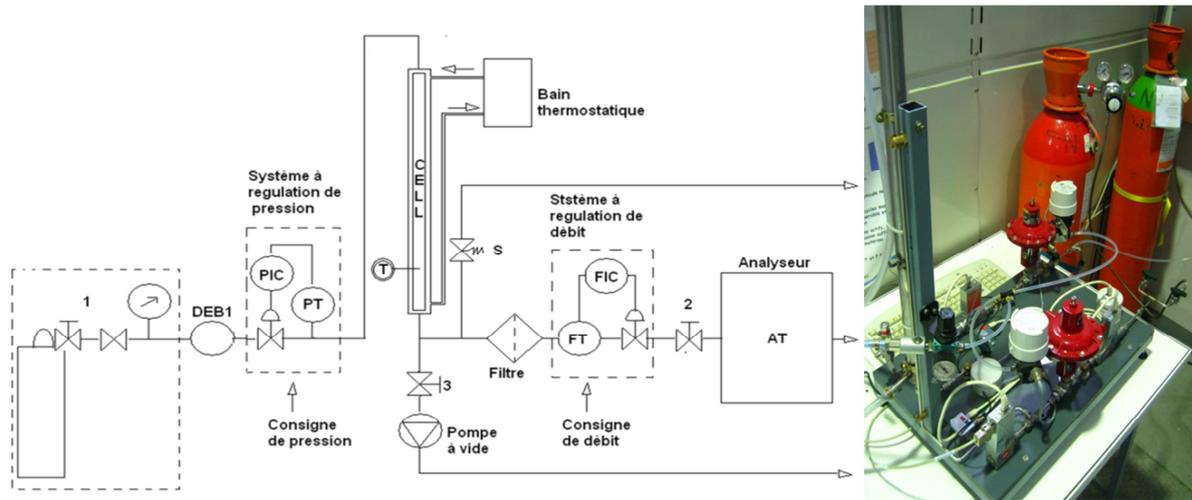
Figure 35. Dispositif expérimental de l'expérience PSA
