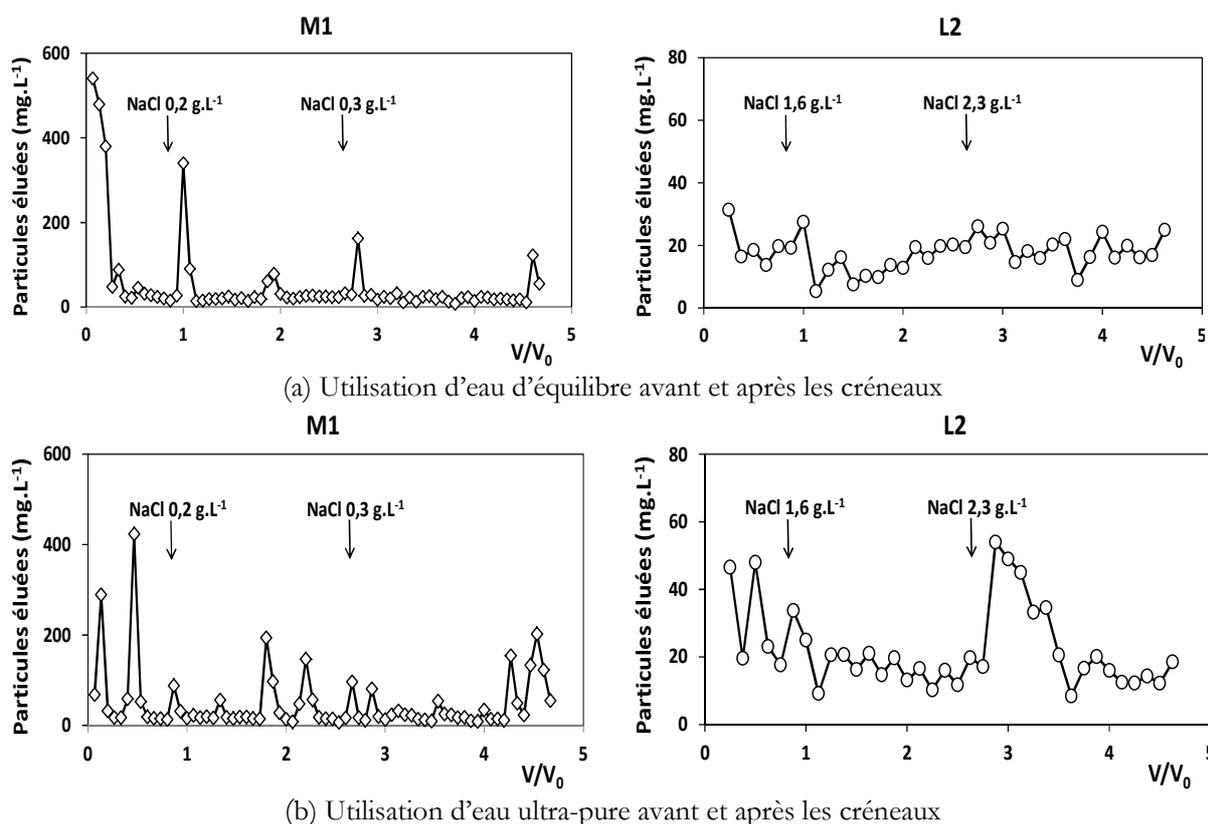
Figure 7. Distribution des particules éluées en zone non saturée après injection de deux créneaux de NaCl (précision  $\pm 2\%$ )
