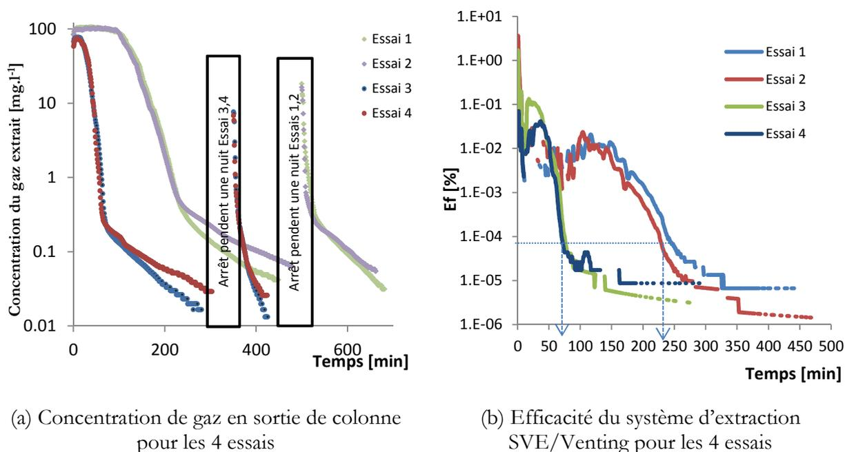
Figure 22. Résultats expérimentaux des essais Venting et SVE
