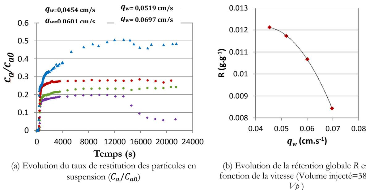
(a) Evolution du taux de restitution des particules en suspension ( $C_a/C_{a0}$ )
