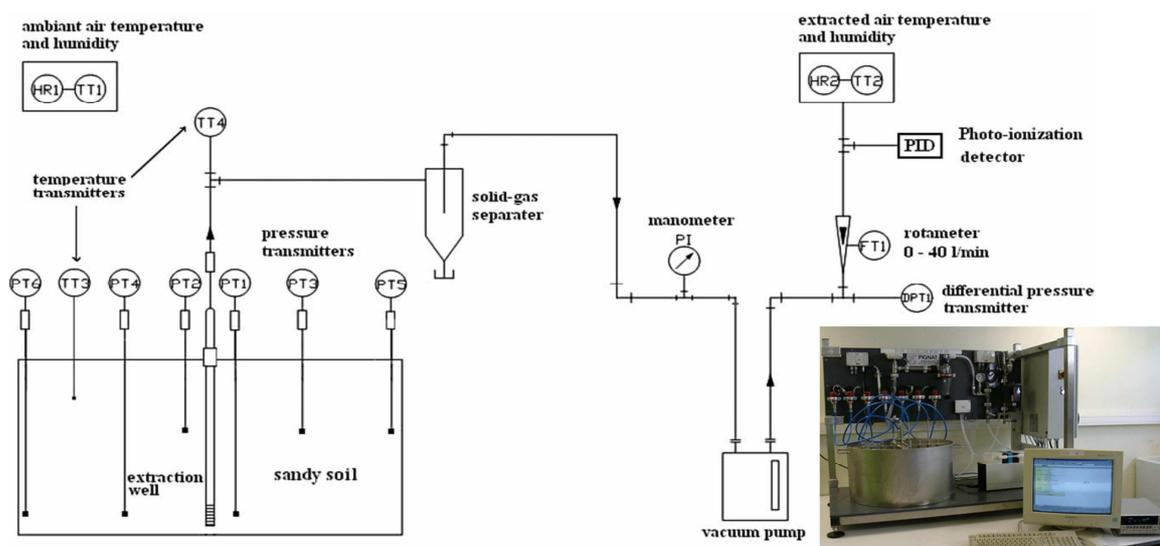
Figure 19. Dispositif expérimental pour l'étude de la SVE
