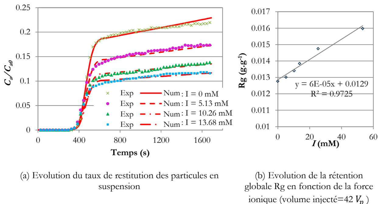
Figure 8. Résultats expérimentaux et modélisation des essais monotones ( $C_{a0} = 1 \text{ g.L}^{-1}$ ;  $q_w = 5,19 \cdot 10^{-2} \text{ cm s}^{-1}$ )
