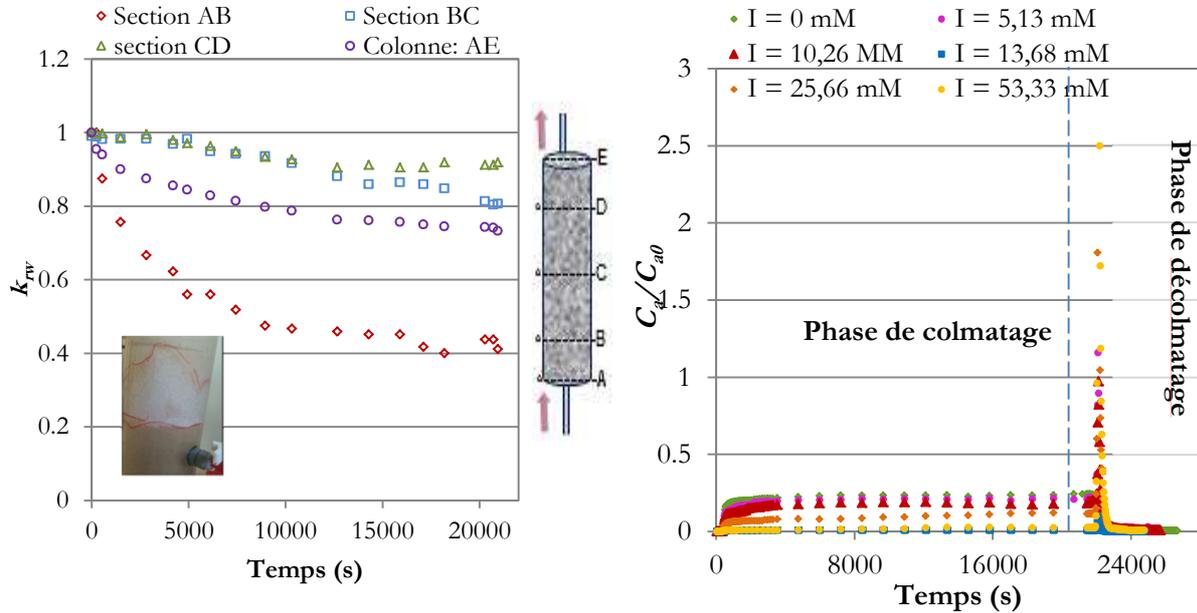
(a) Conductivité hydraulique relative en fonction du temps ( $q_w=0,0519 \text{ cm.s}^{-1}$ ;  $C_{a0}=1 \text{ g.L}^{-1}$ ;  $C_{s0}=0 \text{ g.L}^{-1}$  /  $I=0 \text{ mM}$ )
