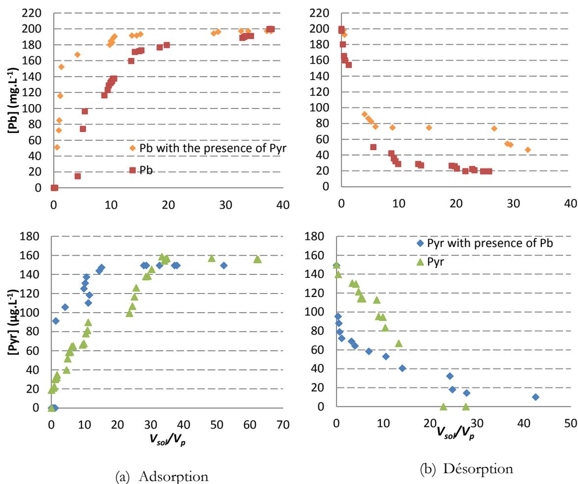
Figure 16. Adsorption et désorption du Pb en présence et en absence du PYR en condition NS à  $\theta=30\%$
