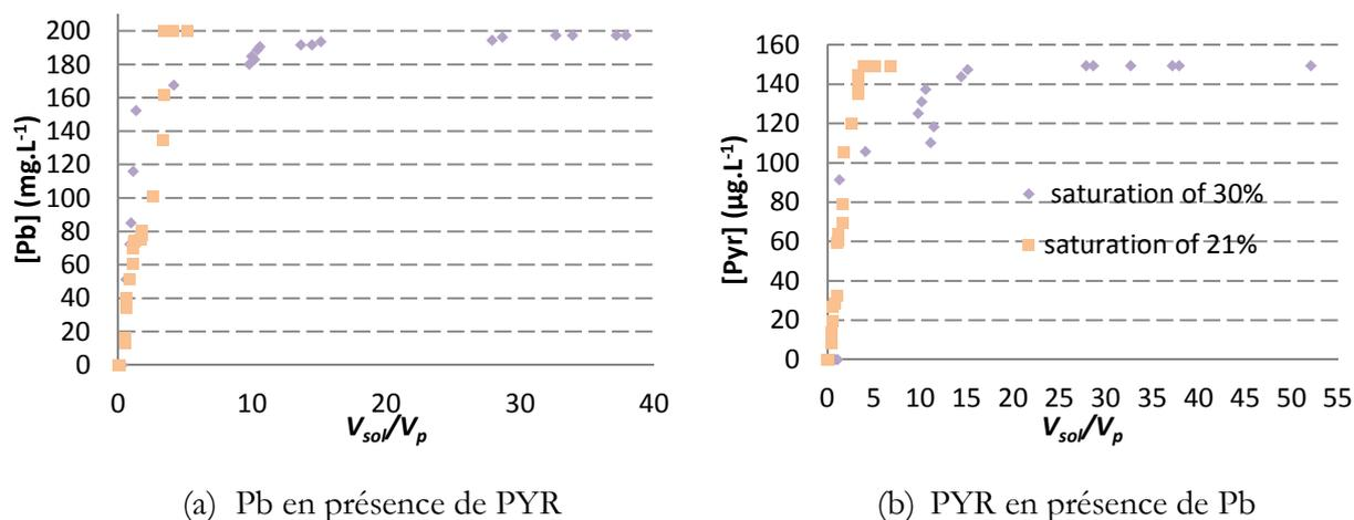
Figure 17. Adsorption mixte à différents degrés de saturation
