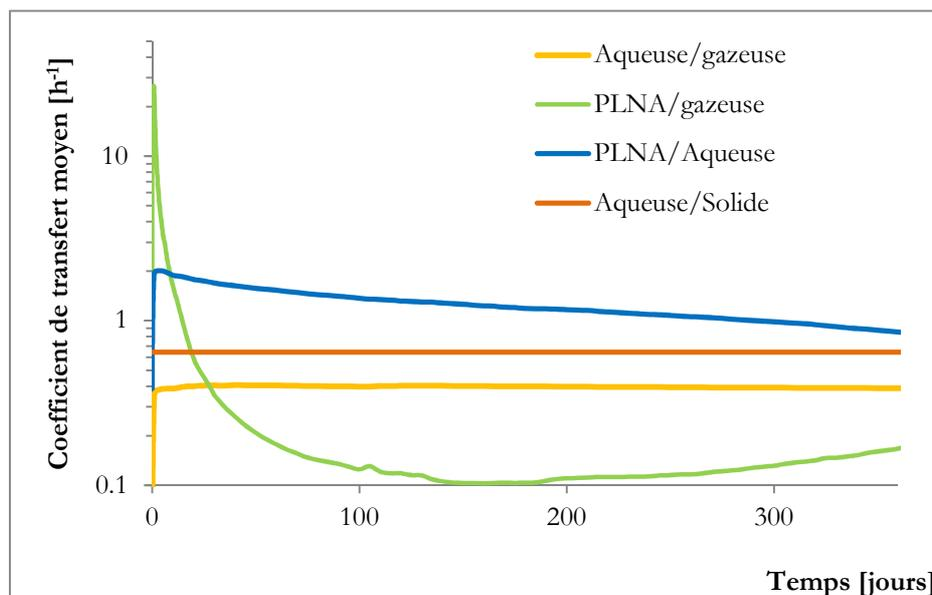
Figure 33. Estimation des coefficients de transferts moyens pour les différentes phases en [h<sup>-1</sup>] (étape MPE)
