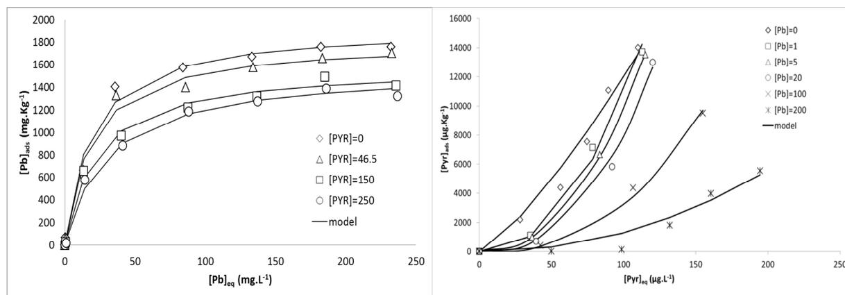
(a) Résultats d'expériences et du modèle Langmuir de l'adsorption du Pb sur sol 1 pour différentes concentrations de PYR [ $\mu\text{g.L}^{-1}$ ] (b) Résultats d'expériences et du modèle Freundlich de l'adsorption du PYR sur sol 1 pour différentes concentrations de Pb [ $\text{mg.L}^{-1}$ ]
