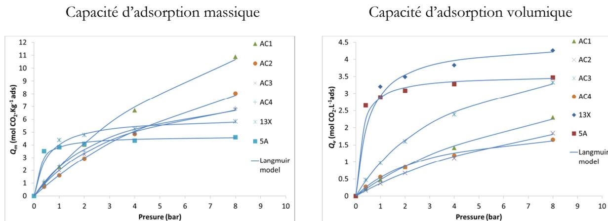
(a) Isothermes d'adsorption du CO<sub>2</sub> pur
