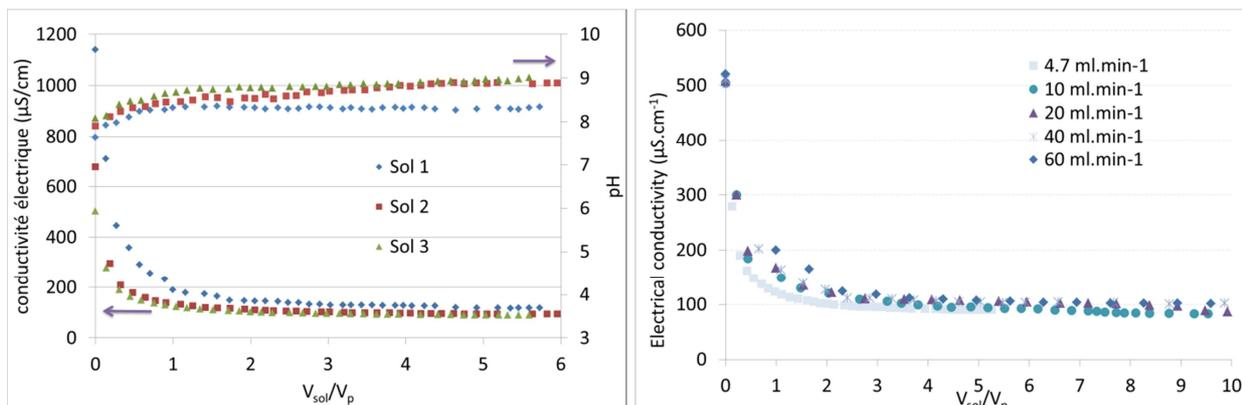
(a) Essais sur les trois sols à différentes profondeurs avec un débit de lessivage de 4,7 ml.min<sup>-1</sup> (b) Essais pour le sol 3 à différents débits (3,5 m de profondeur)
