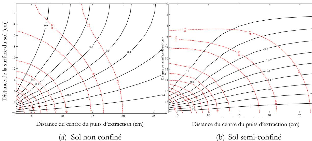
Figure 21. Profil des lignes de courant (lignes noires) et des vitesses de pore (cm.s<sup>-1</sup>, lignes rouges) ( $Q_{vw} = -30,1$  L.min<sup>-1</sup>)
