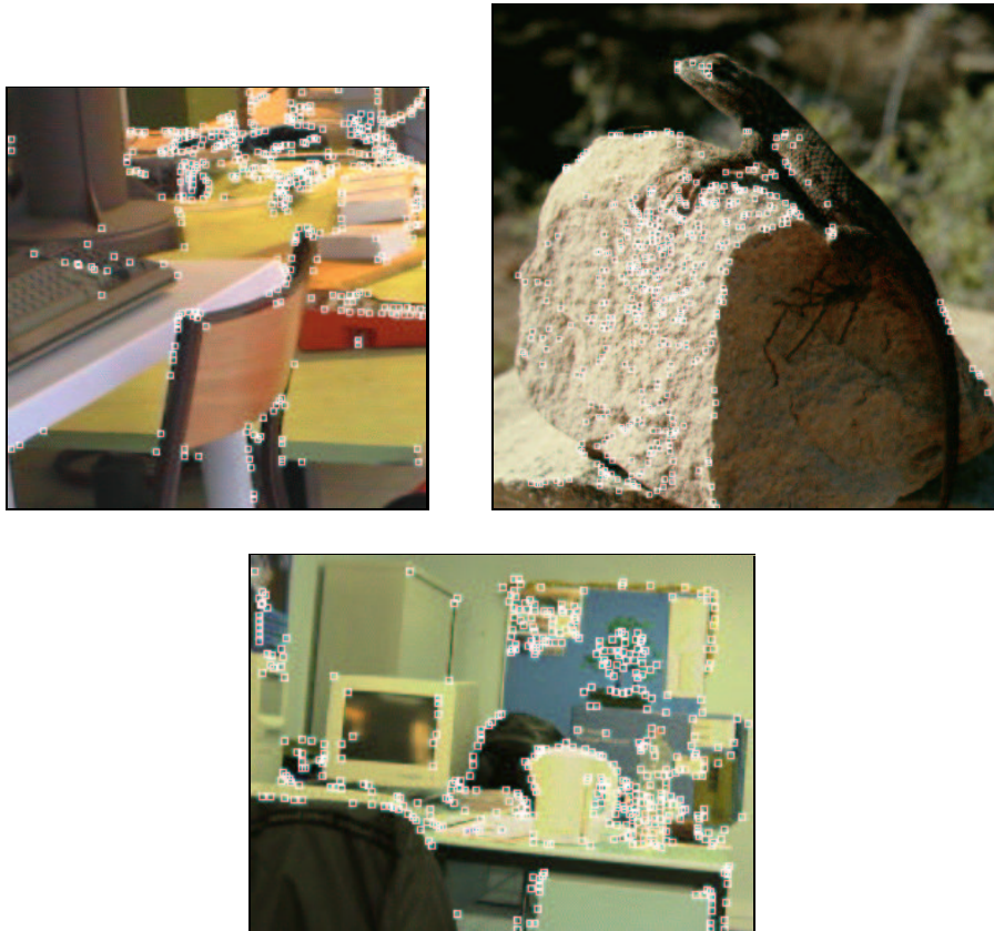
Figure 2.4 – Un exemple de coins couleur sur les images “Salle robotique”, “Lézard” et “Bureau”.
