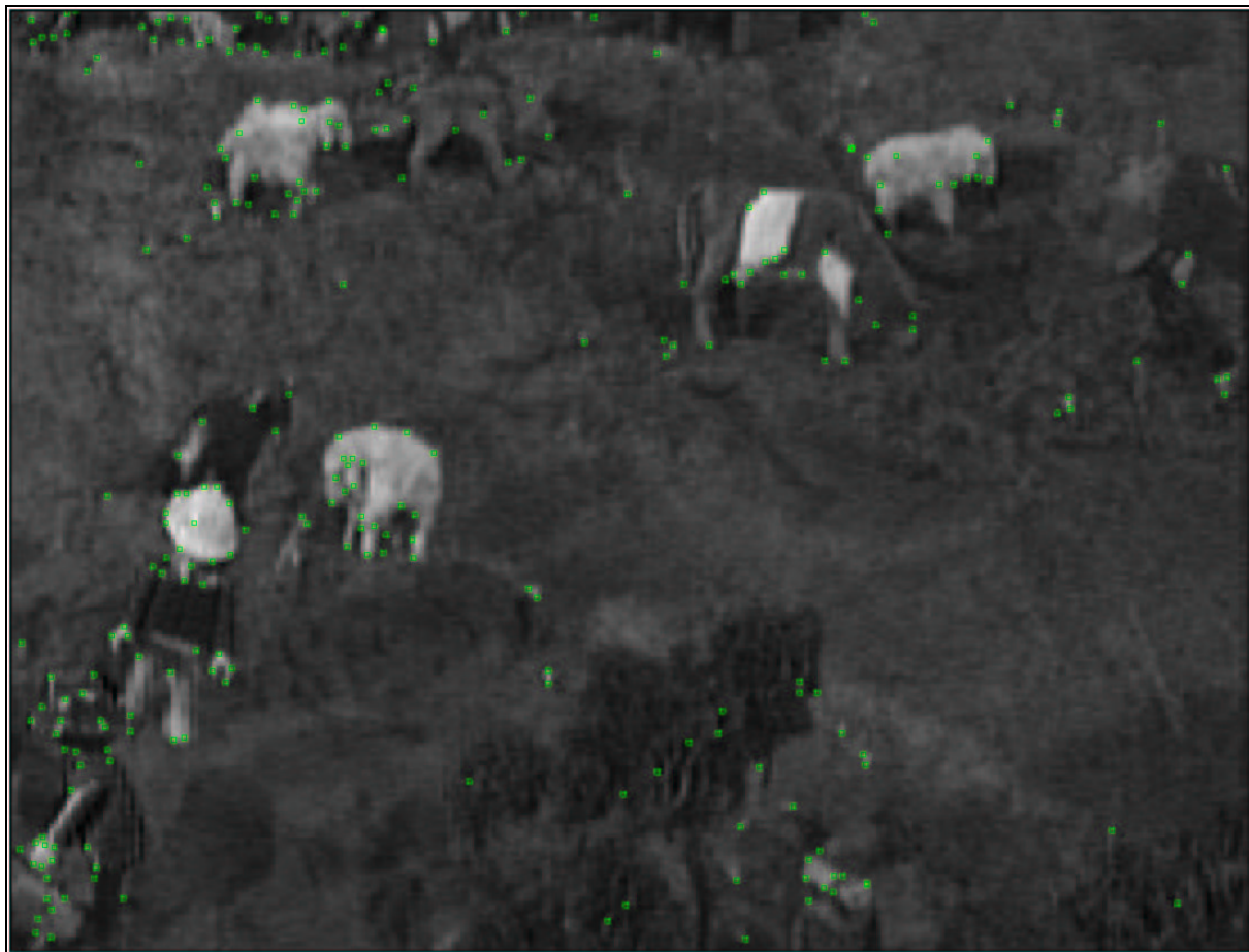
Figure D.19 – Détection de coins couleur en précision quart de pixel (détail des “animaux”).
