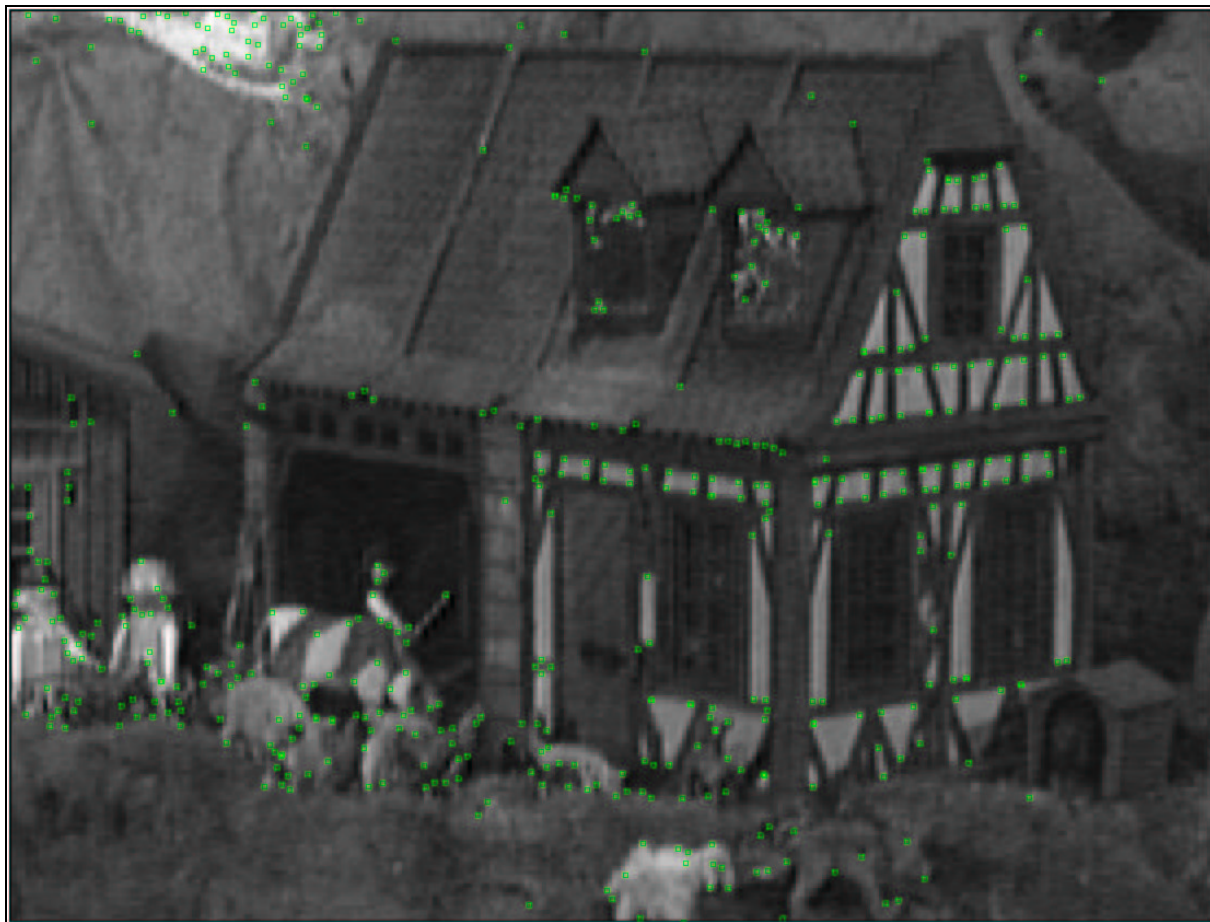
Figure D.17 – Détection de coins couleur en précision quart de pixel (détail des “maisons”).
