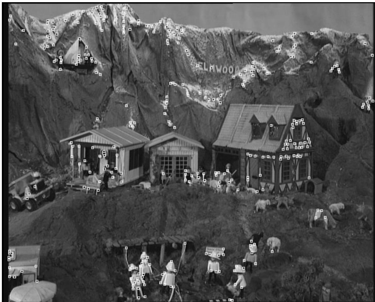
Figure 1.7 – Détection de points Harris Précis Couleur en précision demi-pixel.
