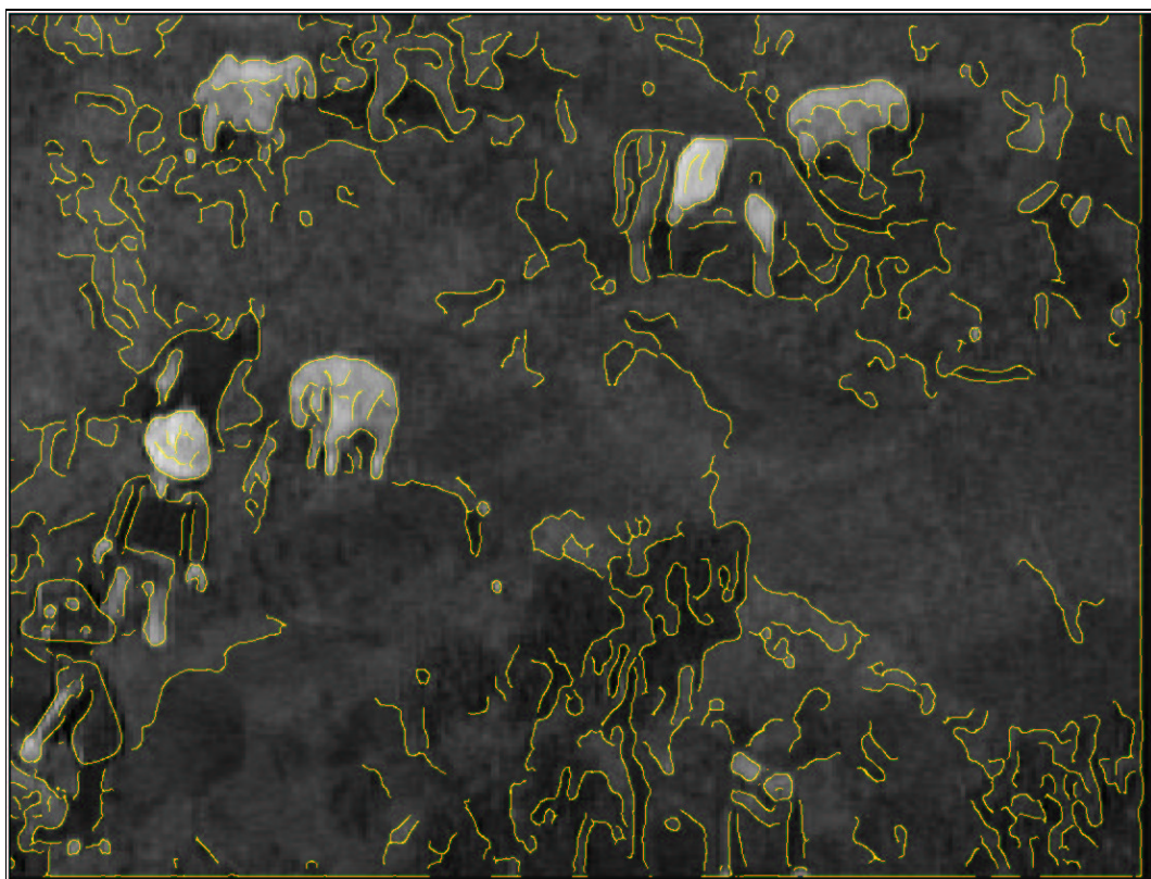
Figure D.7 – Détection de contours couleur en précision quart de pixel par la méthode de Di-Zenzo : détail des “animaux”.
